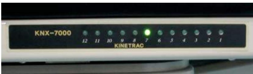
**Рис. 4.** Светодиодная шкала на боковой поверхности рабочей части комплекса
